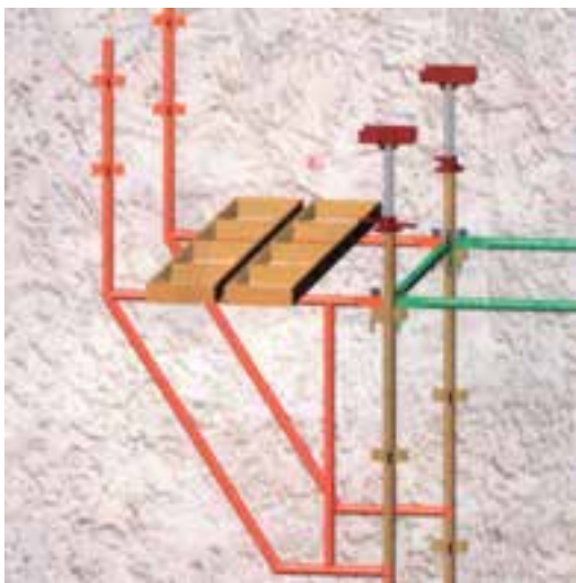
شکل ۷-۴۵ - سکوی کار برای داربست فلزی
