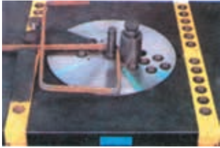
شکل ۶۷-۲- دستگاه خاموت خم کن برقی
