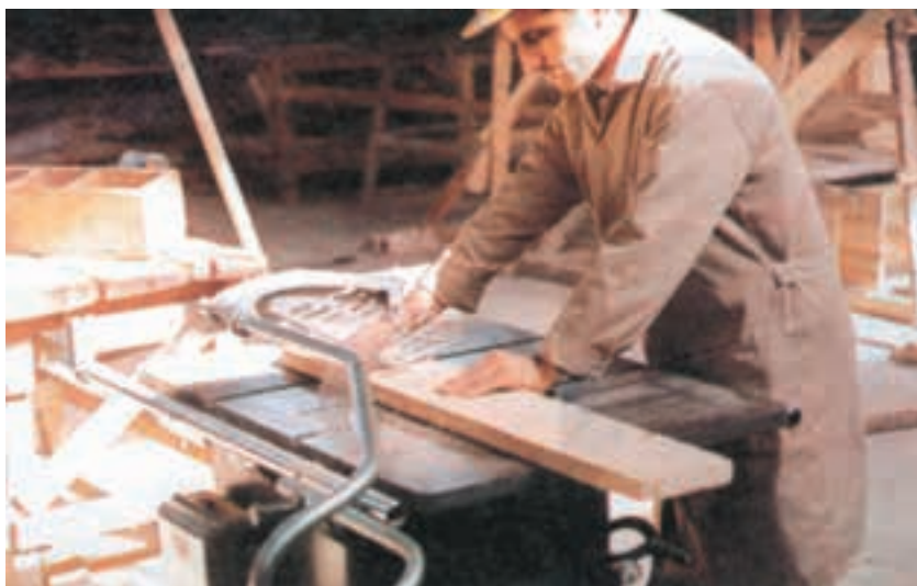
شکل ۱-۶۵- روش بریدن عرضی تخته با ارّه گرد برقی میزی
